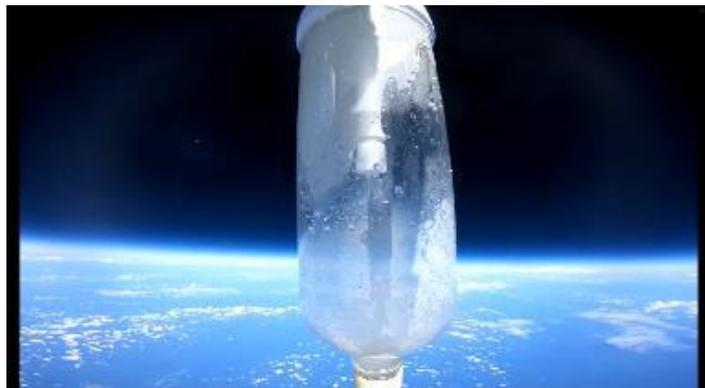
バルーンによる成層圏からの落下による微小重力試験
